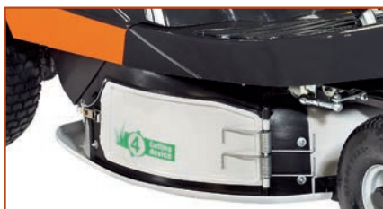
"4-cutting device": ευέλικτο σύστημα κοπής που περιλαμβάνει κόψιμο (mulching), συλλογή και πλευρική εκκένωση, με εκτροπέα για την πίσω εκκένωση.
