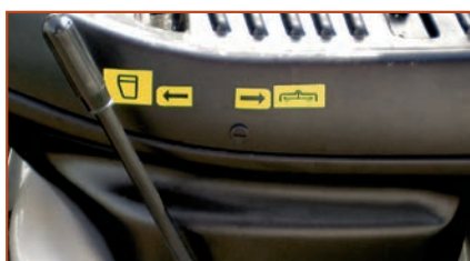
Mulch/collect "Change over" system: Χρησιμοποιώντας έναν εύχρηστο μοχλό, ο χειριστής μπορεί να κλείσει τον αγωγό συλλογής και να μεταβεί αυτόματα σε λειτουργία κοψίματος (mulching), χωρίς διακοπή.
