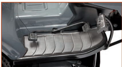
Νέα τρακτέρ γκαζόν πλευρικής εκκένωση με ταχύτητα ελεγχόμενη μέσω ενός διπλού πεταλιού που λειτουργεί απευθείας στο υδροστατικό κιβώτιο. Αυτή η λύση επιτρέπει την αντιστροφή της κατεύθυνσης της διαδρομής και τον ακριβή έλεγχο της ταχύτητας κατά τη λειτουργία.
