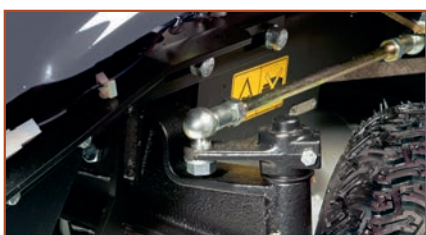
Μηροσπινός άξονας από χάλυβα για να αντέξει ακόμη και τις βαρύτερες εργασίες και να αντιστέκεται σε τυχαίες κρούσεις.
