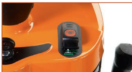
Ο ηλεκτρομαγνητικός συμπλέκτης ενεργοποιείται γρήγορα και αθόρυβα μέσω ενός εύχρηστου κουμπιού που έχει τοποθετηθεί στο ταμπλό.
